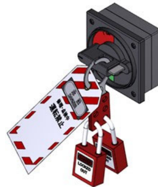
図 1-5-05 ロックアウト/タグアウトの例
