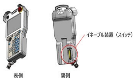
図 1-3-34 ティーチングペンダントの例 (イネーブル装置を装備)
