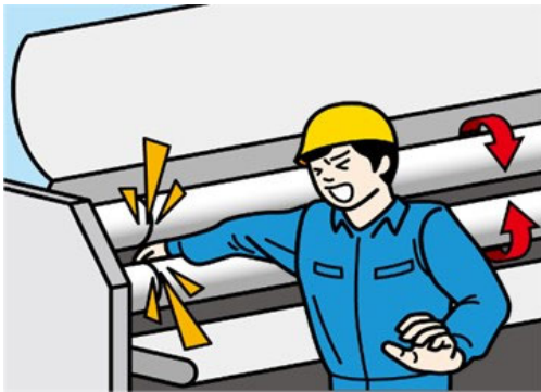
図 1-5-04 ローラへ腕が巻き込まれた場合など、ローラが解放できるなどの対処方法を決めておく
