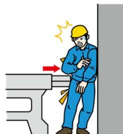
図 1-3-05 押しつぶされないよう隙間を設ける
