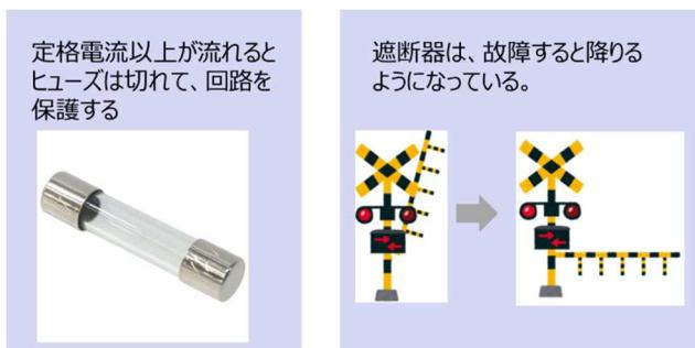
図 1-3-18 非対称故障モードの部品、装置の例
