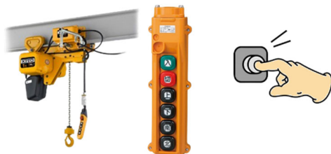
図 1-4-27 ホールド・ツゥ・ラン制御の例
