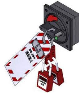
図 1-5-05 ロックアウト/タグアウトの例
