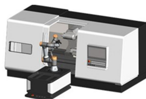
図1-3-12 ワークの搬入/搬出は自動化で実施
