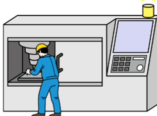
図 1-4-32 ISO12100 によるガード選択の例
