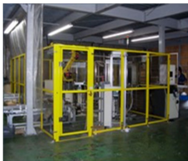
図1-4-02 「隔離の安全」(固定式ガード)
