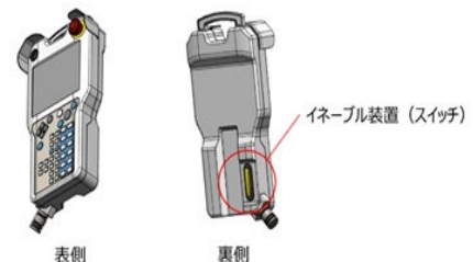
図1-3-34 ティーチングペンダント の例(イネーブル装置を装備)
