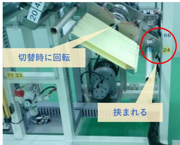
図 8 間欠的に発生するピンチポイントの例
