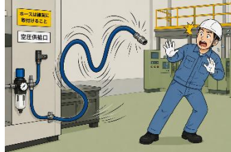
図表 138 外れた高圧のホースは人に危害を加える可能性がある
