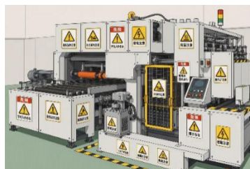
図表 109 注意/警告マークをたくさん張り付けてリスク低減を行ったつもりの機械の例
