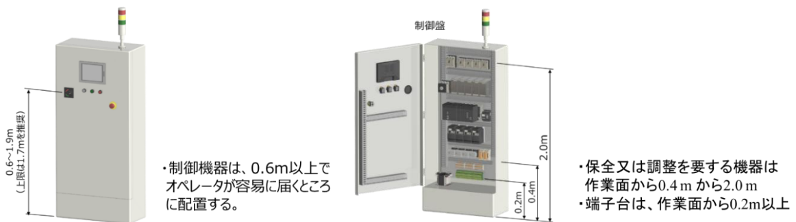
図表 131 操作機器類の適切な高さ/位置
