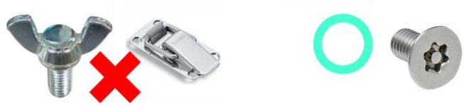
図表 155 固定式ガードの取付け (手で外せるねじの使用は不可)
