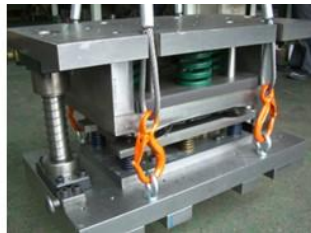
図表 189 重量部品の安全な取り扱い手段の例
