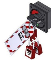
図表 188 ロックアウト/タグアウトの例
