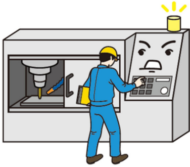
【図 01-06】：ガードが開いていると機械は動かない
