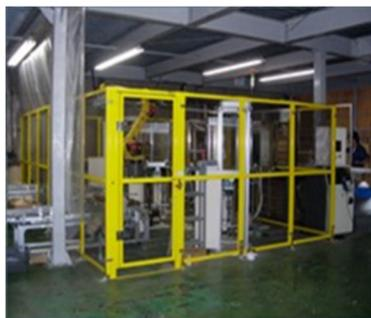
図 1-4-02 「隔離の安全」(固定式ガード)
