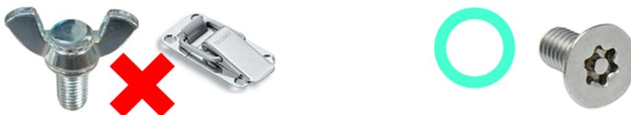
図 1-4-10 固定式ガードの取付け
